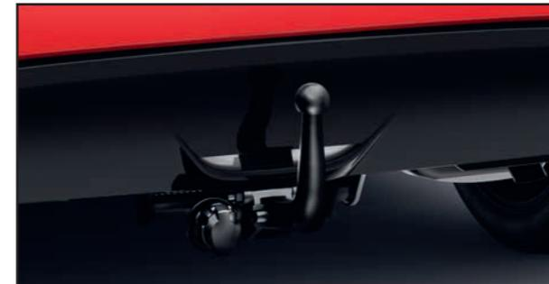
Anhängezugvorrichtung mit abnehmbarer Kupplungskugel, horizontale Verriegelung
